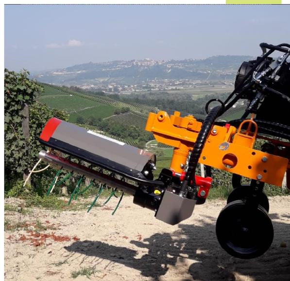
Testata Falciaerba ad azionamento idraulico con tastatore a molla regolabile per il taglio contro il filare.
