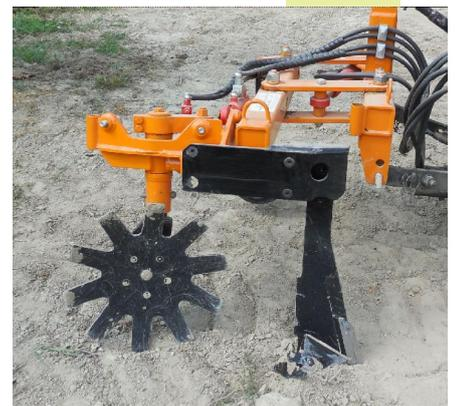
A seconda delle vostre particolari esigenze, consentono di effettuare un diserbo meccanico e una lavorazione superficiale del terreno nel sottofila e nel lungofila.
